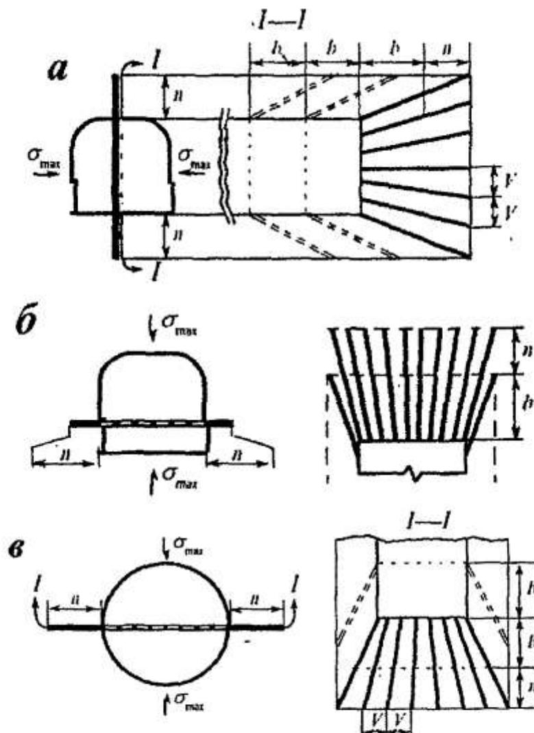
Рис. 1. Схемы камуфлетного взрывания по рядам шпуров:
