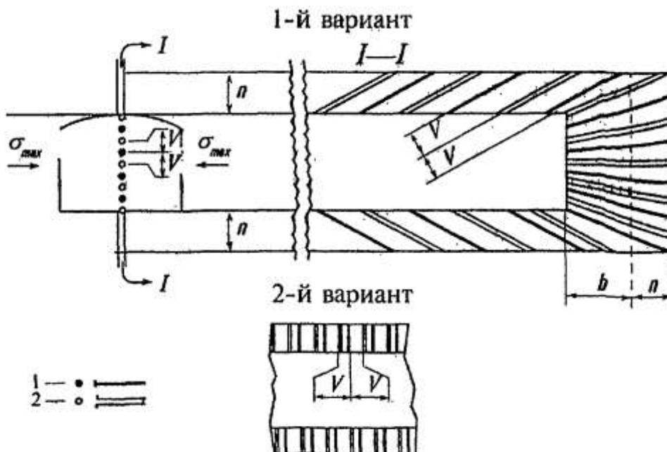
Рис. 3. Схемы применения камуфлетных и компенсационных скважин (шпуров).
