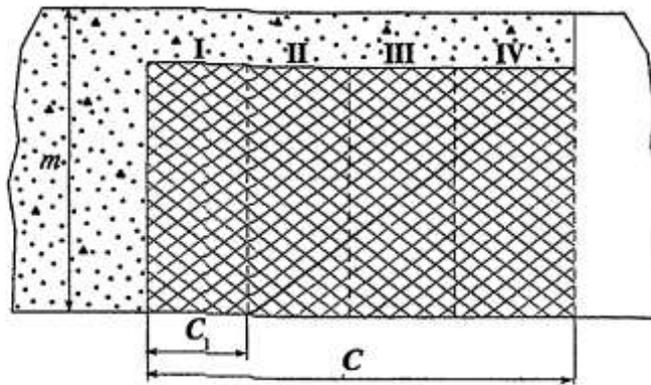
Рис. 14. Построение защищенной зоны при опережающей отработке рудного тела.
