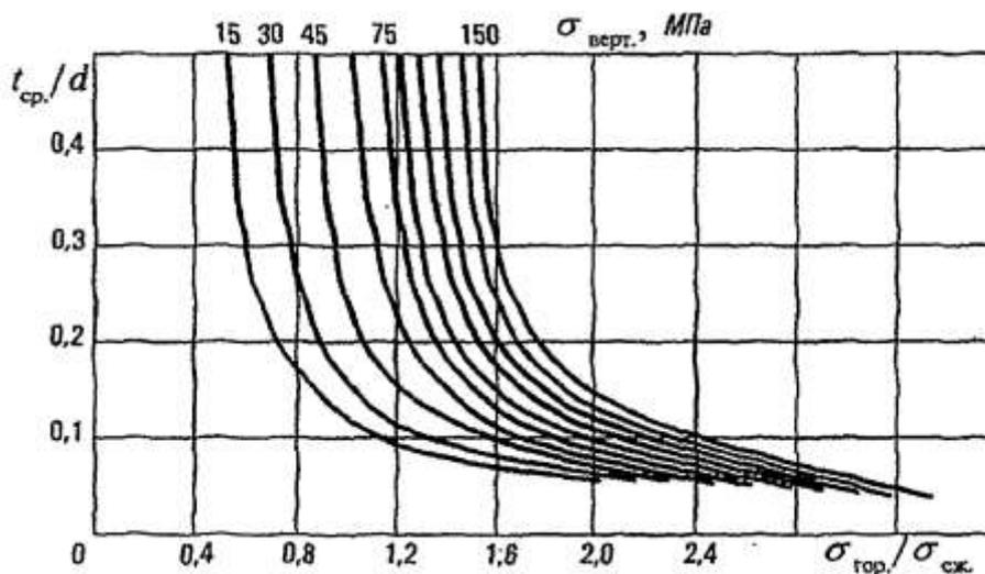
**Рис. 12.** Номограмма для оценки напряженного состояния пород  $\sigma_{гор.}/\sigma_{сж.}$  по дискванию керна по данным бурения геологоразведочных скважин при различных вертикальных напряжениях, определяемых величиной  $\gamma H$  :
