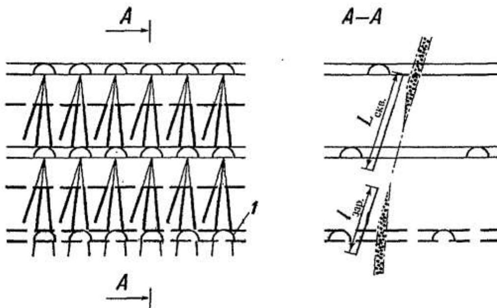
Рис. 4. Схема расположения скважин вблизи тектонического нарушения.
