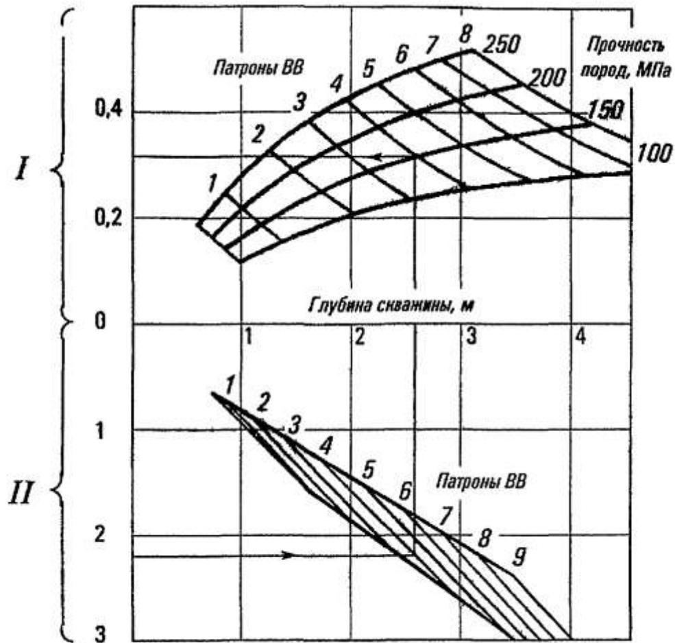
Рис. 2. Номограмма для определения параметров камуфлетного взрыва ряда шпуров (масса патронов ВВ 0,2 кг)  $I$  — относительная длина заряжаемой части скважины;  $II$  — расстояние до максимума напряжений, м.
