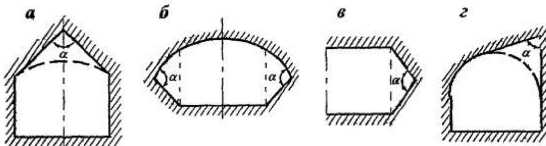
Рис. 5. Полигональная форма выработок при расположении мест разрушения:
