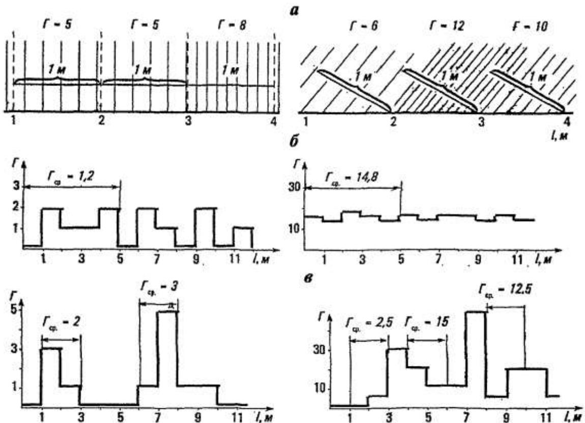
Рис. 10. Определение интенсивности трещин:
