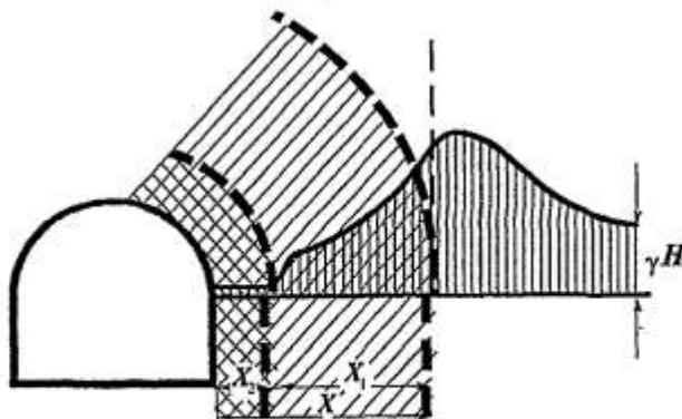
Рис. 8. Схема, иллюстрирующая положение зоны дискования  $X_1$ .  $X$  — расстояние от обнажения до зоны максимума опорного давления;  $X_1 = X - X_2$ ;  $\gamma$  — удельный вес породы;  $H$  — глубина разработки
