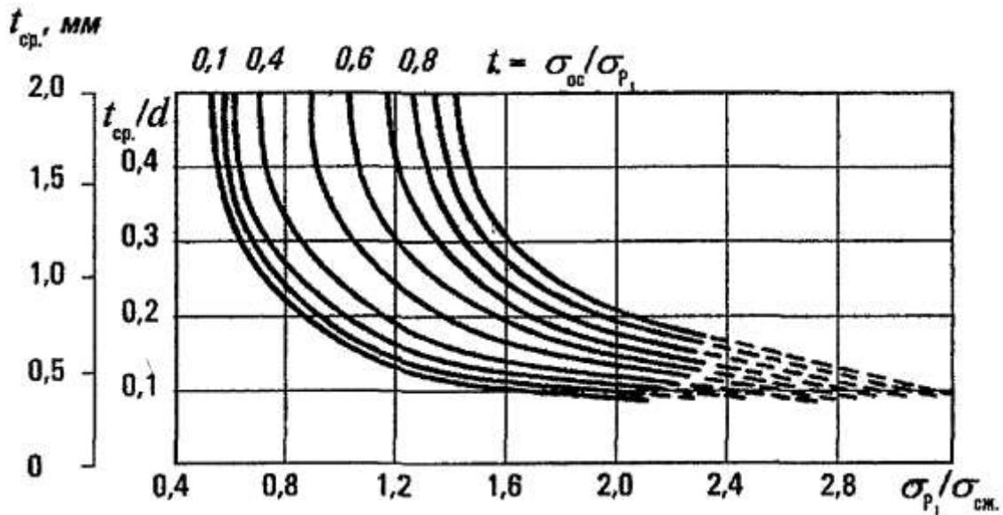
Рис. 6. Зависимости параметров дискования керна  $t_{cr}/d_{disc}$  от уровня напряженности массива  $\sigma_{P1}/\sigma_{сж}$  при различных соотношениях между осевыми и радиальными напряжениями  $\sigma_{0c}/\sigma_{P1}$ :
